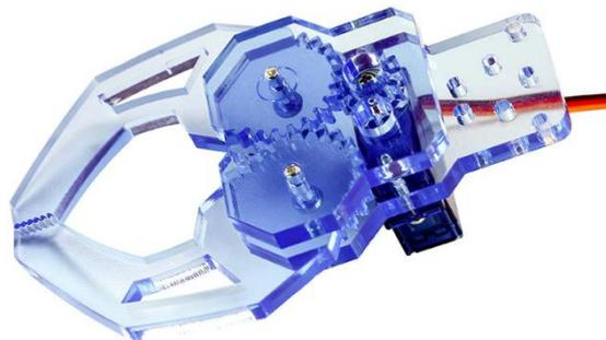
Figure 5 Pince à Double Engrenage
