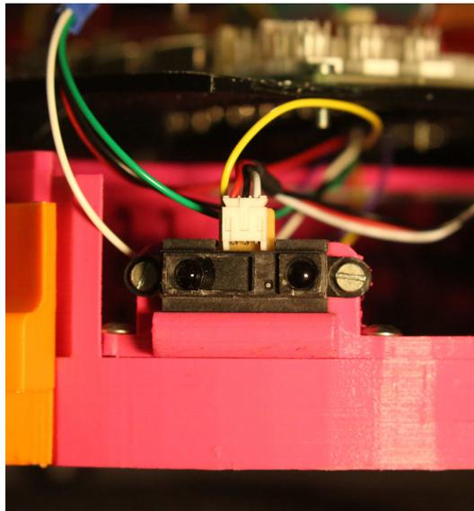
FIGURE 9 – Télémètre infrarouge installés sur le robot
