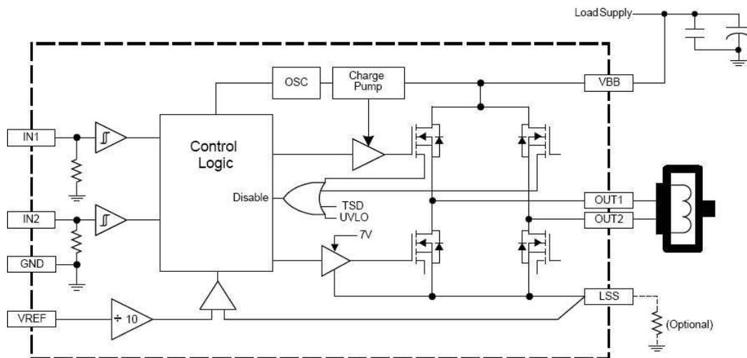
FIGURE 6 – Hacheur A4950 : diagramme fonctionnel
