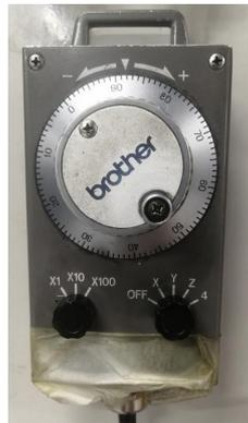
FIGURE 5 – Télécommande de la machine
