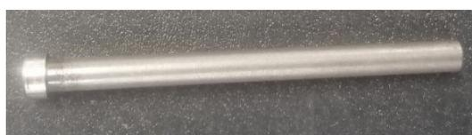
FIGURE 13 – Vis en acier après matriçage
