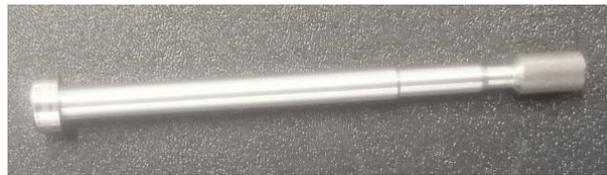
FIGURE 20 – Pièce reprise sur le centre d'usinage horizontal
