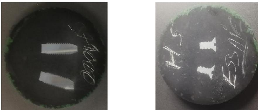
FIGURE 24 – Echantillon pour macro/micrographie
